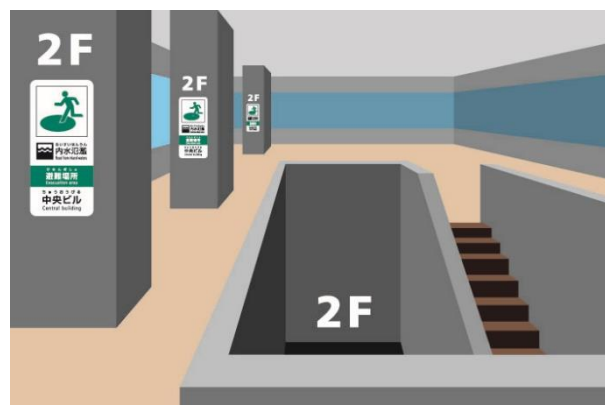
f) 建物内の柱に内水氾濫避難場所標識を設置した例（屋内の場合）。
