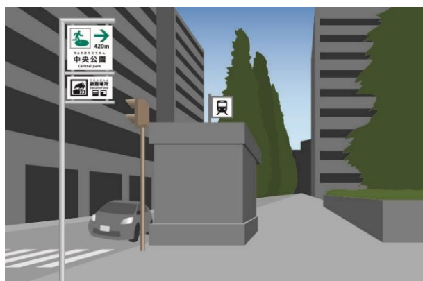
d) 市街地の道路にポール式（補助標識つき）の大規模な火事避難誘導標識を設置した例。
