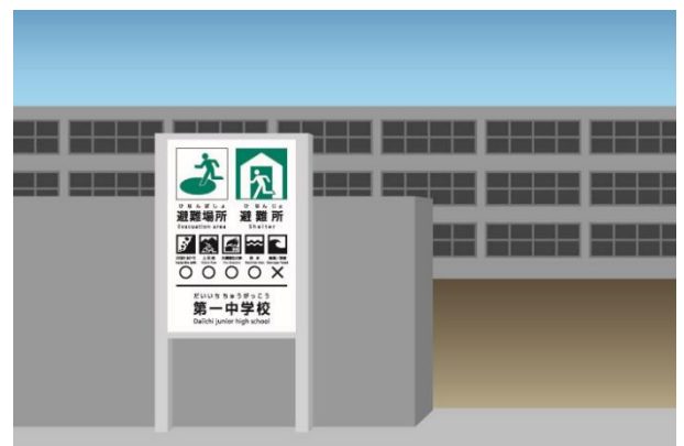
f) 校舎の正門前に自立式の崖崩れ・地滑り避難場所標識を設置した例(避難所を兼ねている)。
