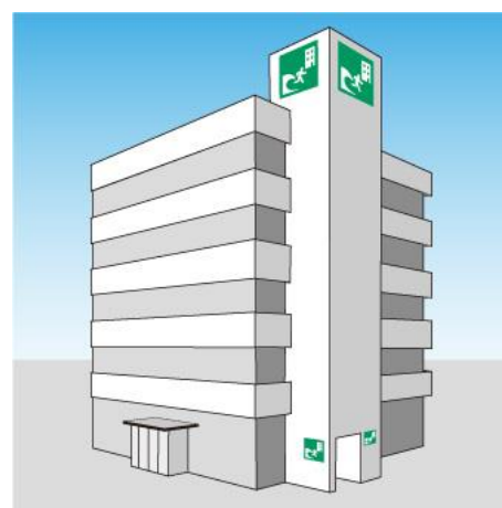
f) ビルの屋上及び1階出入りに津波避難誘導標識を設置した例。
