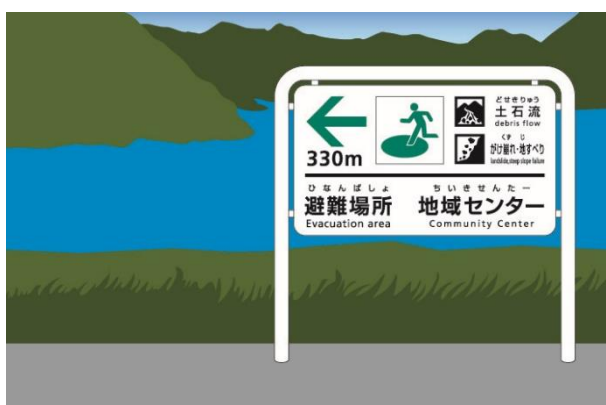
e) 川に沿った道路に自立式の土石流避難誘導標識を設置した例。
