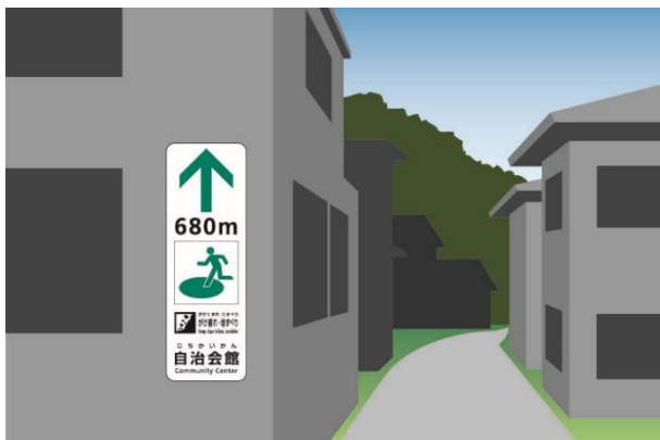
c) 建物の壁面に崖崩れ・地滑り避難誘導標識を設置した例。
