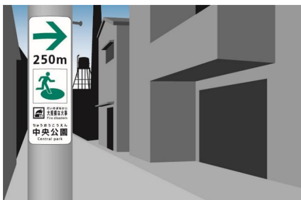
c) 電柱に大規模な火事避難誘導標識を設置した例。
