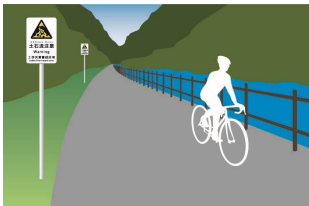
a) 山裾の道路脇にポール式の土石流注意標識を設置した例。
