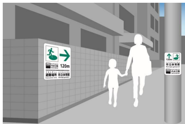
b) 建物の壁面及び電柱に内水氾濫避難誘導標識を設置した例（屋外避難場所）。
