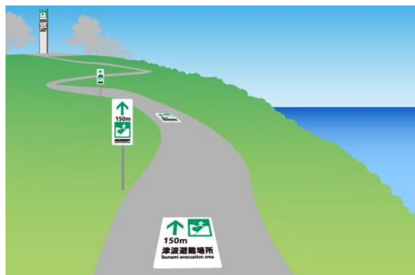
c) 小高い丘の上に繋がる歩道の脇及び路面に津波避難誘導標識を設置した例。
