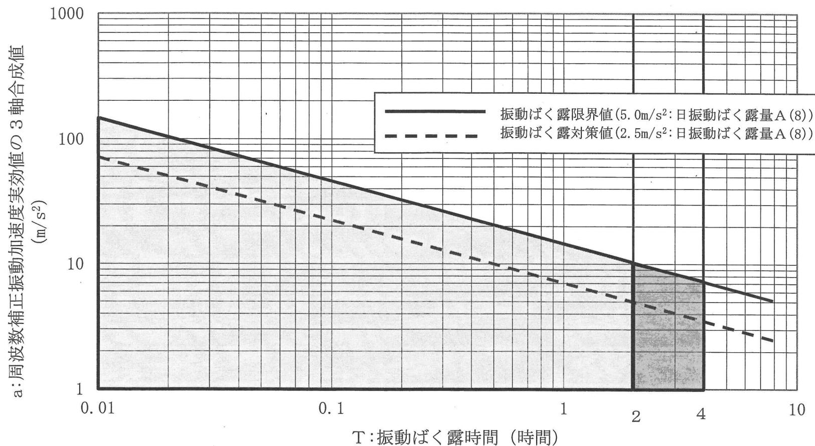
振動ばく露限界値 (5.0m/s<sup>2</sup>: 日振動ばく露量 A(8)) 以下で第1の3 (2) ウ本文の場合
