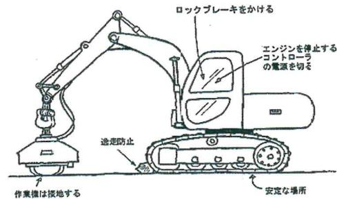
ただし、走行運転位置と作業運転位置が異なる場合で、作業装置の運転位置で運転し、または運転しようとしている場合は、逸走を防止する措置を講じさせてください。
