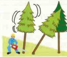
(図4) かかり木に激突させるためにかかり木以外立木の伐倒
