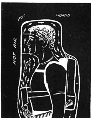
耐熱服下の個人冷房器の取付状態を示す。
