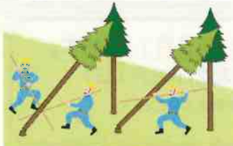
(図2)かかり木の処理
