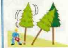
(図2)かかり木に激突させるためにかかり木以外の立木の伐倒
