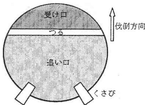
図3 くさびの打ち込み位置の例
