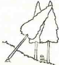
(図3)かかっている立木の伐倒
